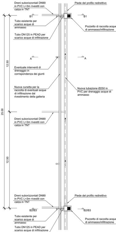
**PARTICOLARE IN CORRISPONDENZA DEI POZZETTI PER LO SMALTIMENTO DELLE ACQUE DI AMMASSO/INFILTRAZIONE**
