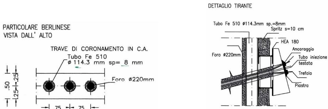
Figura 7.2 - Disegni contabili: particolari paratia esistente in prossimità della rotatoria.
