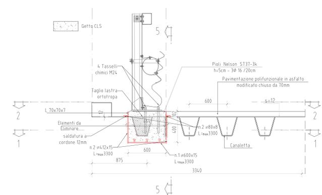
**PARTICOLARE SEZIONE LONGITUDINALE SEZIONE 5-5**
