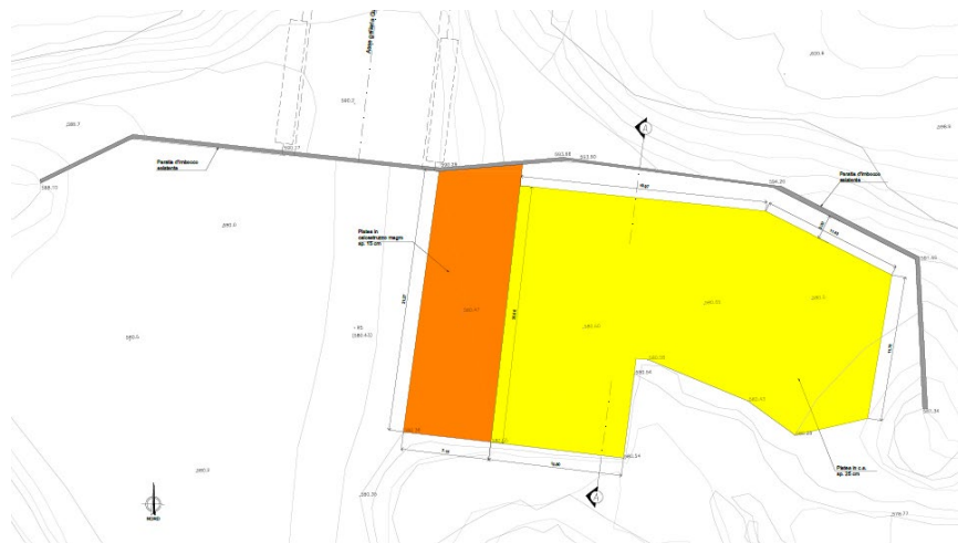
Figura 32 – Galleria Guinza- Imbocco lato Umbria – Demolizione della soletta in cls magro
