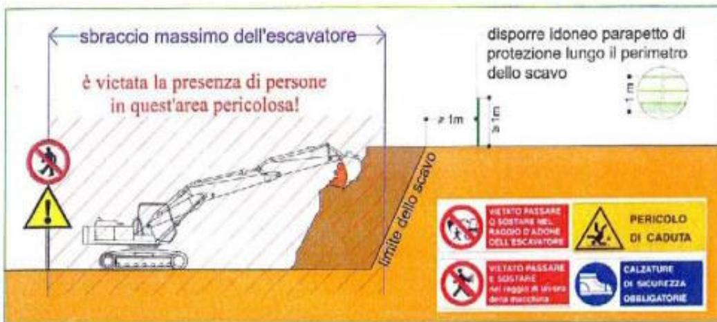
Nello scavo di trincee profonde più di 1,50 m, quando la consistenza del terreno non dia sufficiente garanzia di stabilità anche in relazione alla pendenza delle pareti, si deve provvedere, man mano che procede lo scavo, all'applicazione delle necessarie armature di sostegno.
