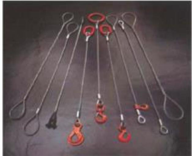
Le funi che costituiscono questo tipo di brache di solito sono realizzate in acciaio lucido (zincato o inossidabile per usi particolari) flessibile a 6 trefoli ed anima tessile o metallica.
