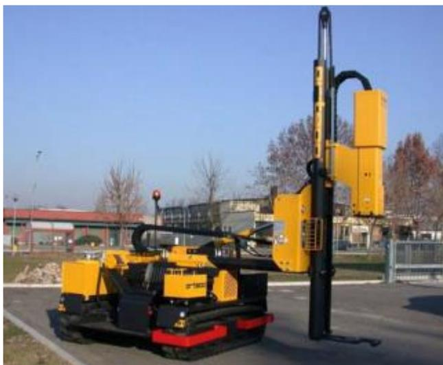
Il sistema a vibrazione può essere a vibroinfissione oppure a vibroinfissione a colpi:
