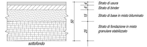
**PARTICOLARE B - RIFACIMENTO SOVRASTRUTTURA STRADALE ESISTENTE**
