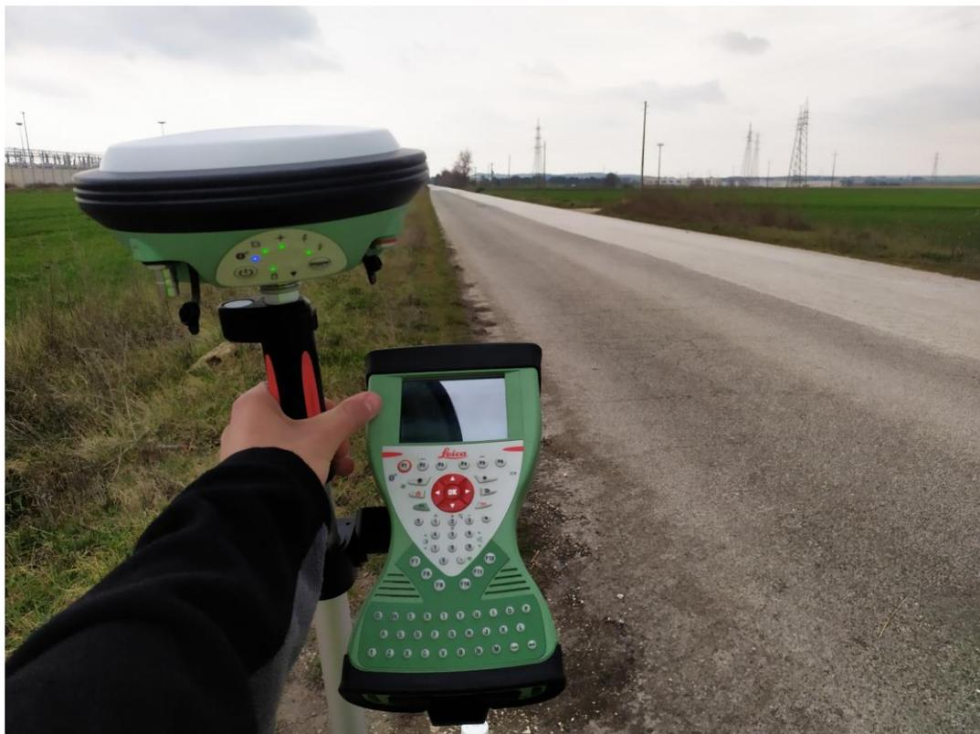
Figura 4: Leica GS14 in modalità statica
