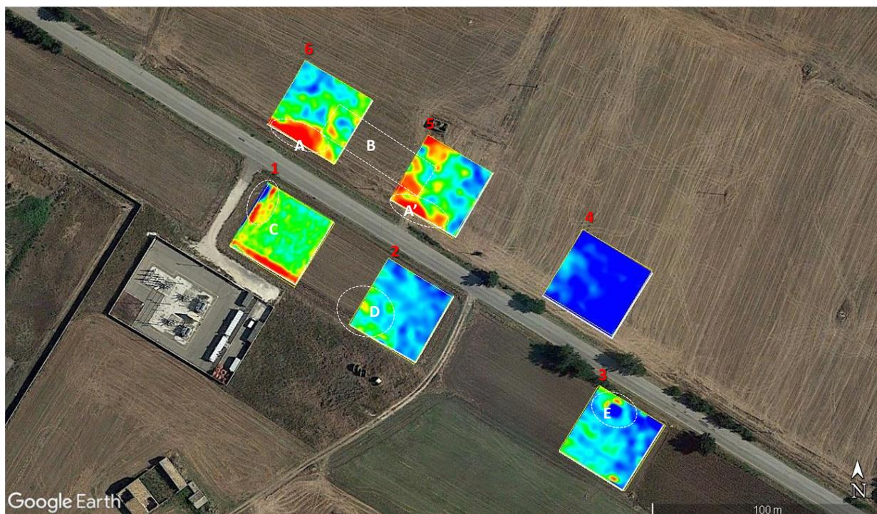
Figura 13: Mappe numerate da 1 a 6 (in rosso) della componente verticale del gradiente geomagnetico ridotta al Polo sovrapposte alla foto aerea. Sono indicate le zone anomale individuate con forme a linee tratteggiate e denominate con lettere da A ad E.
