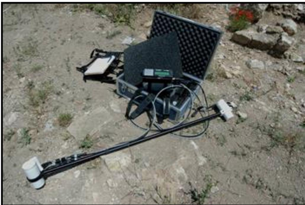
Figura 2: Magnetometro a protoni con effetto Overhauser in assetto gradiometrico; i due sensori sono posti ad una distanza di 56 cm.
