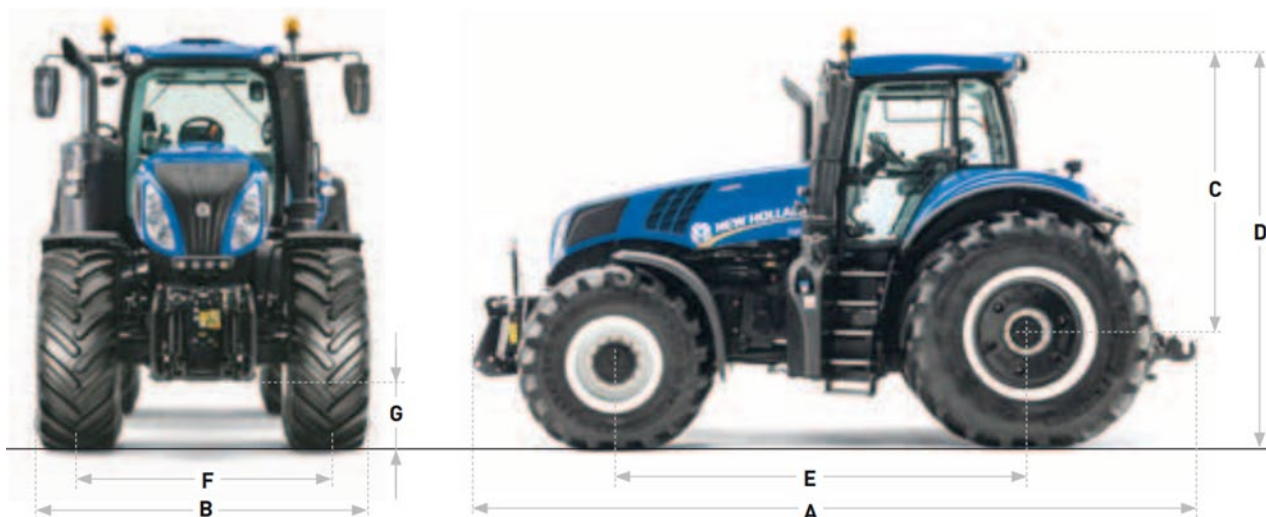
Dimensioni del più grande dei trattori gommati convenzionali prodotti dalla NEW HOLLAND
