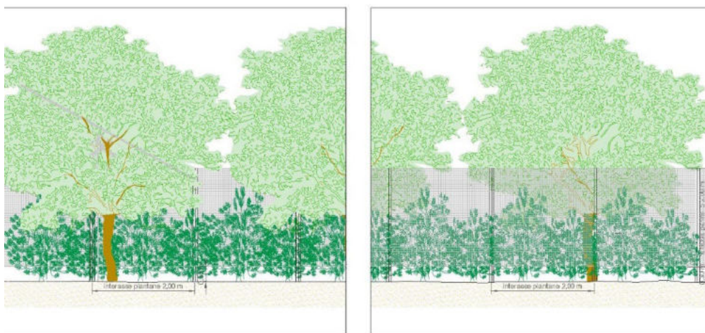
Fig. 14 - Dettaglio della recinzione dell'impianto agro-fotovoltaico
