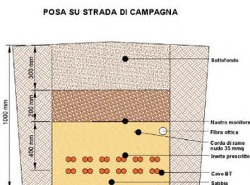
Figura 19 – Particolare sezione tipo cavo interrato BT
