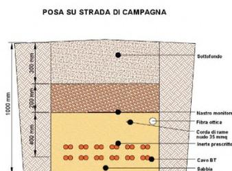
Fig. 30 – Sezione tipo-posa cavi BT
