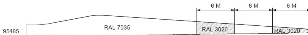
Figura 6.1 – Schema indicativo colorazione pale (la larghezza effettiva delle bande colorate sarà apposta in accordo con quanto specificato in Tabella 6.2)
