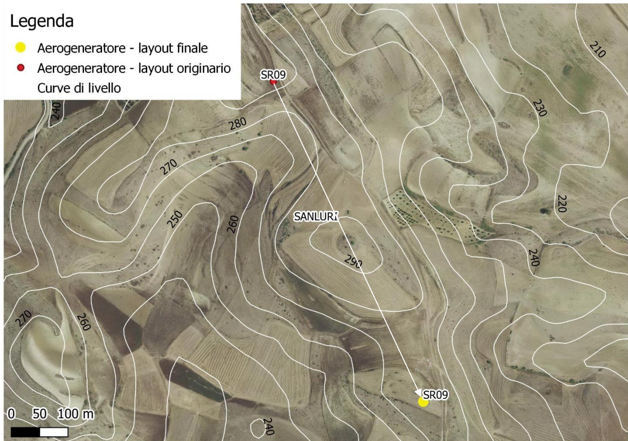
Figura 6.2 Evoluzione del layout originario (rosso) e layout di progetto (giallo), postazione SR09
