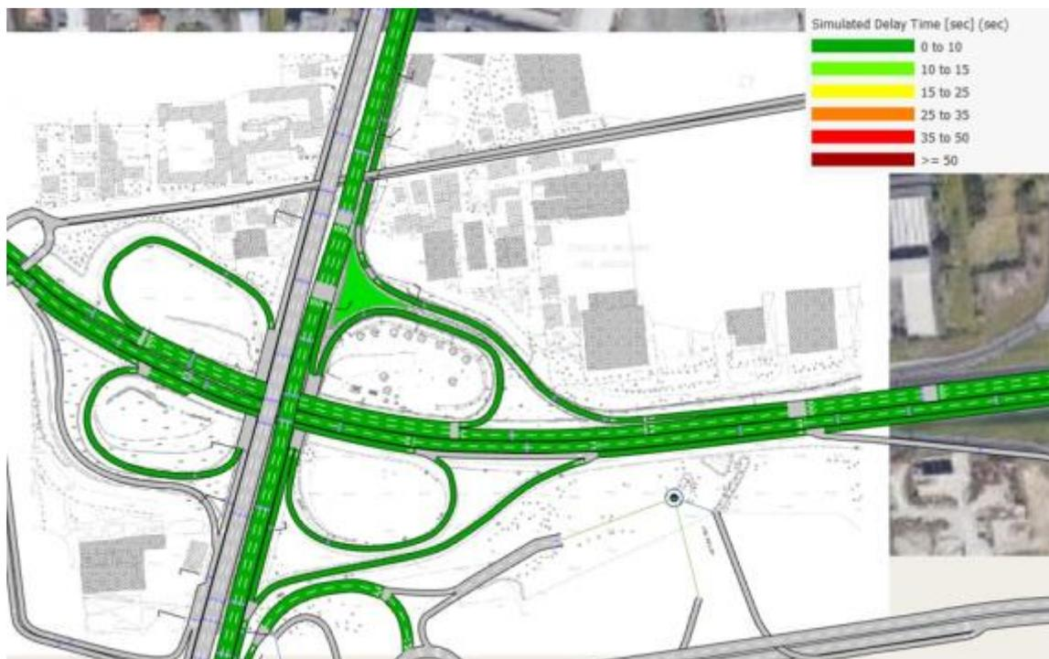
Figura 7-11 Scenario di progetto: valori del perditempo medio veicolare
