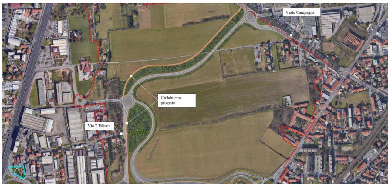
La pista sarà realizzata al termine del bosco e quasi a contatto con i campi coltivati, ma separata da essi tramite uno stretto bordo mantenuto a prato largo circa 1 metro.
