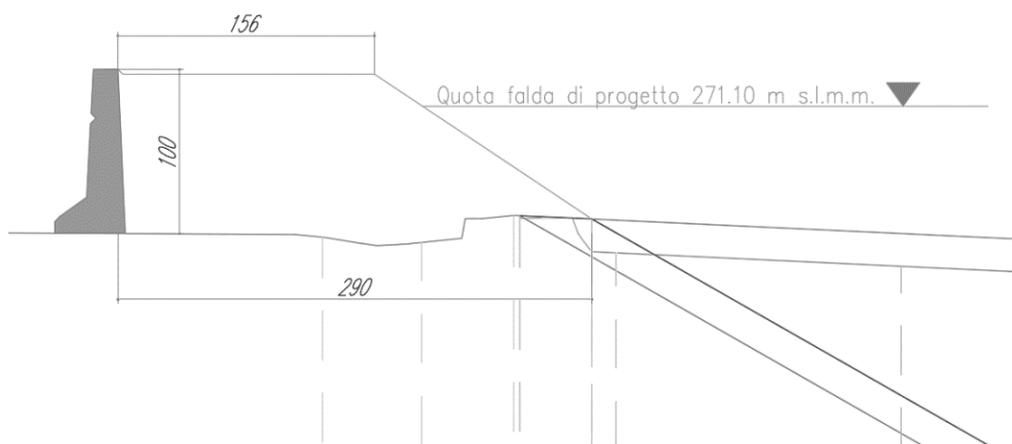
Figura 13-11 Sezione tipologica dell'argine
