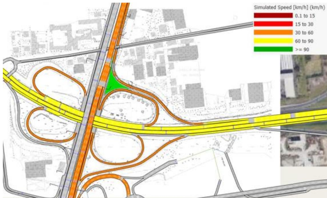
Figura 7-12 Scenario di progetto: valori della velocità media veicolare
