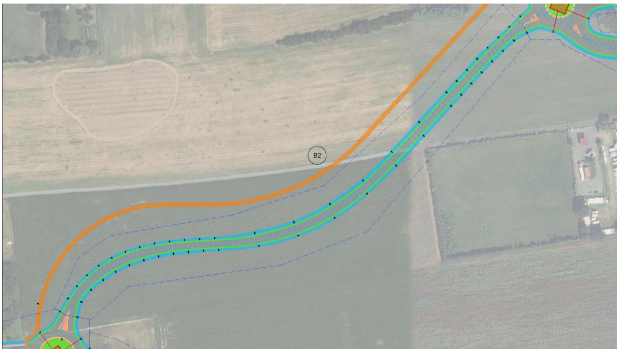
Figura 8.8 Stralcio planimetrico del sistema di drenaggio del Ramo 4 (IR03).
