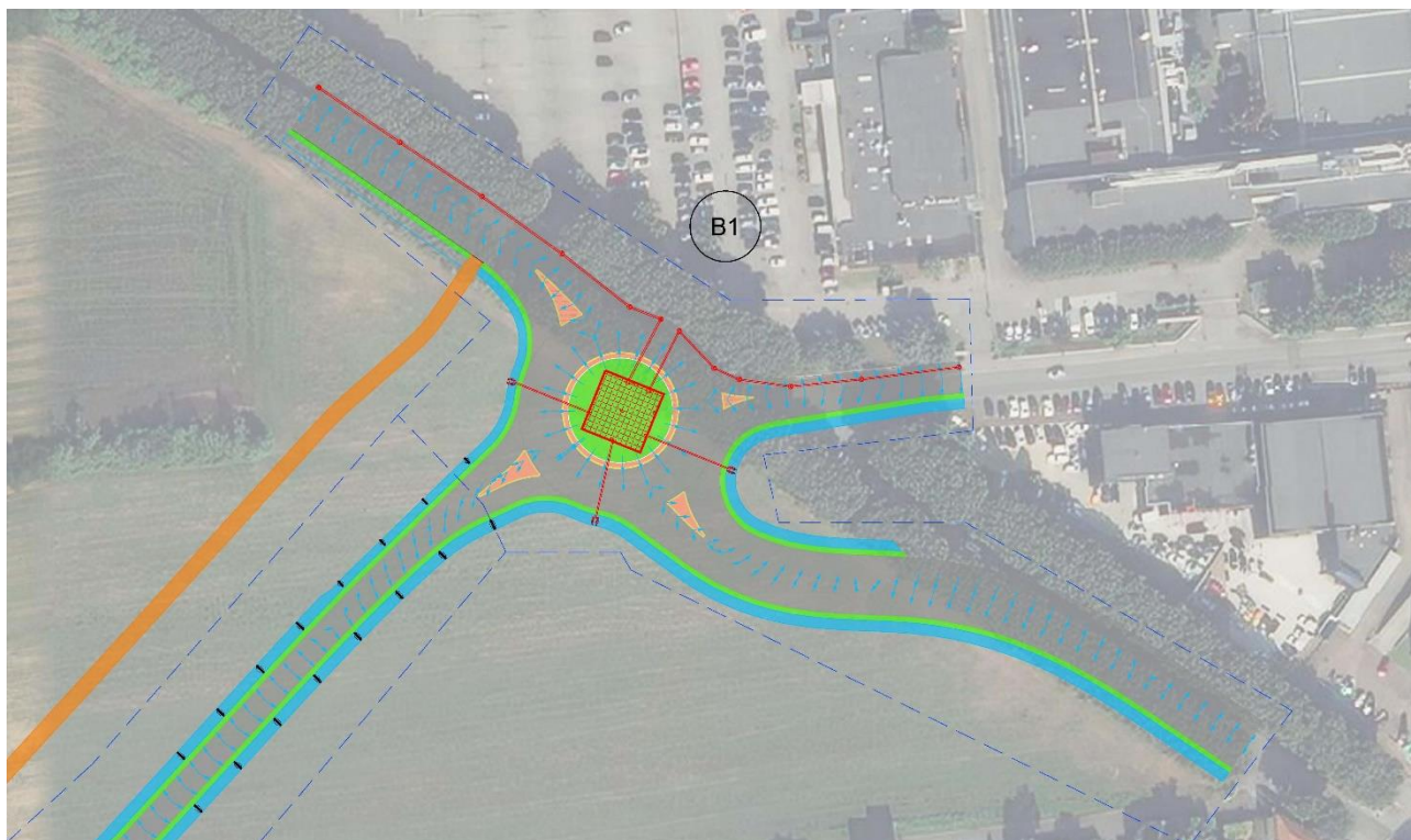
Figura 8.9 Stralcio planimetrico del sistema di drenaggio della Rotatoria R2 (IR02).
