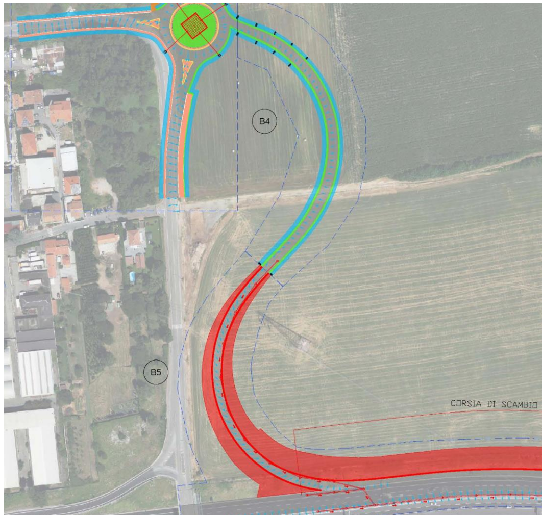
Figura 8.6 Stralcio planimetrico del sistema di drenaggio del Ramo 3 (TR05).
