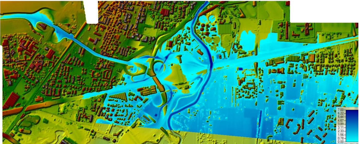
Figura 6.32: Simulazione con i massimi tiranti di allagamento.
