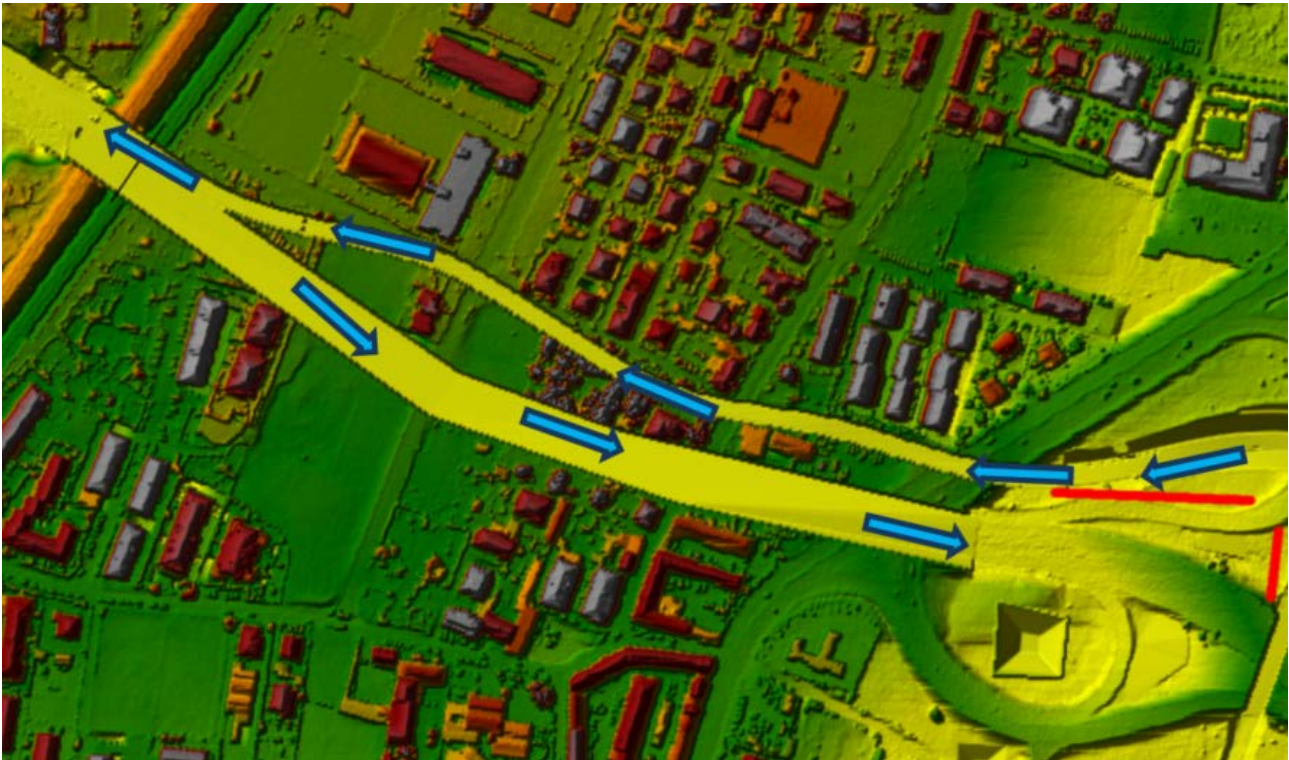
Figura 4.8 – Modifica della dinamica di propagazione delle esondazioni nel caso di inserimento degli argini. Con frecce azzurre la direzione del flusso
