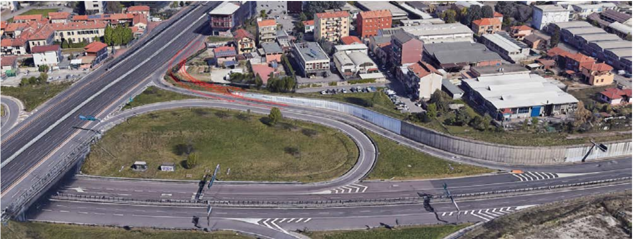
Figura 3.36 – Vista “a volo d’uccello” da sud dell’area dello svincolo A52-SS36 ove è previsto lo spostamento a lati della rampa di uscita esistente (fonte Google Earth)
