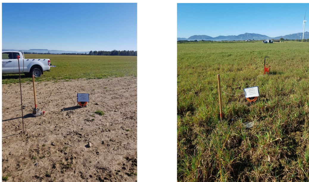
Figura 7 - Allineamento geofonico in agro di Pabillonis (diretto a sinistra e inverso a destra).
