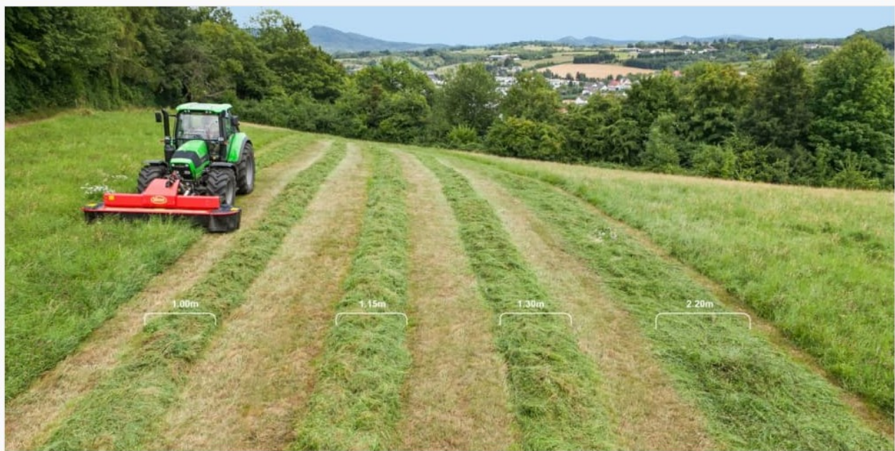
Figura 18 - Immagine della falciatrice anteriore e larghezze delle andane realizzabili
