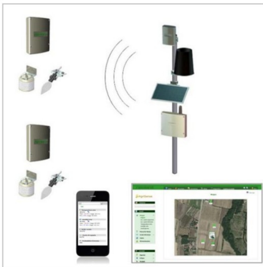
Figura 19 - Stazione principale e sensori meteo climatici.
