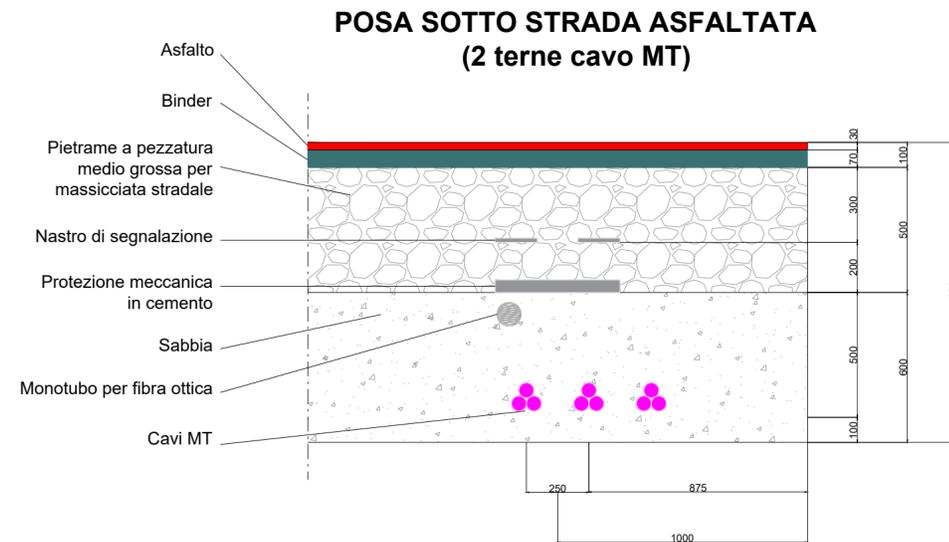
PARTICOLARI COSTRUTTIVI - CAVIDOTTO AT
