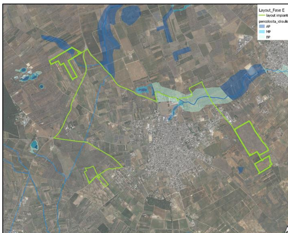
Figura 1: Planimetria dell'area di interesse con reticolo idrografico interferente e fasce PAI
