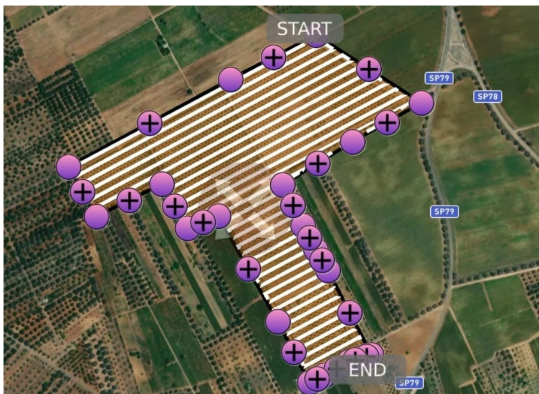
Figura 4 - Esempio di pianificazione di una missione di volo con Pix4Dcapture (Cellino San Marco - Area Nord)
