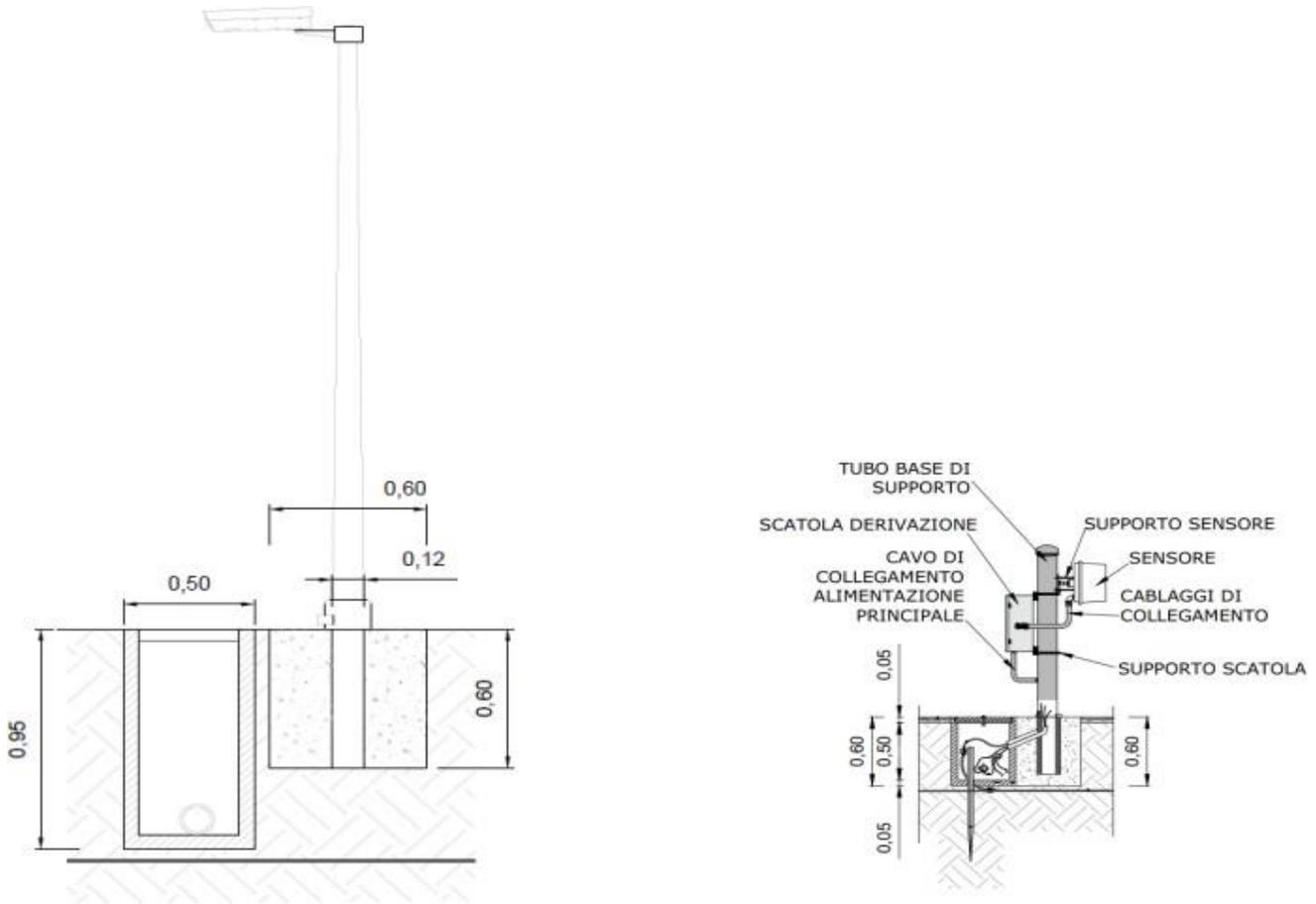
Figura 74– Sistema antintrusione con barriera a microonde
