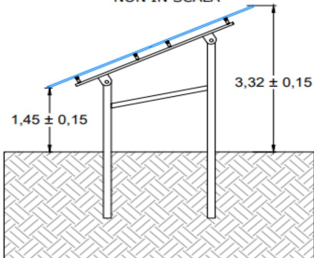
Figura 68 – Strutture di sostegno fisse
