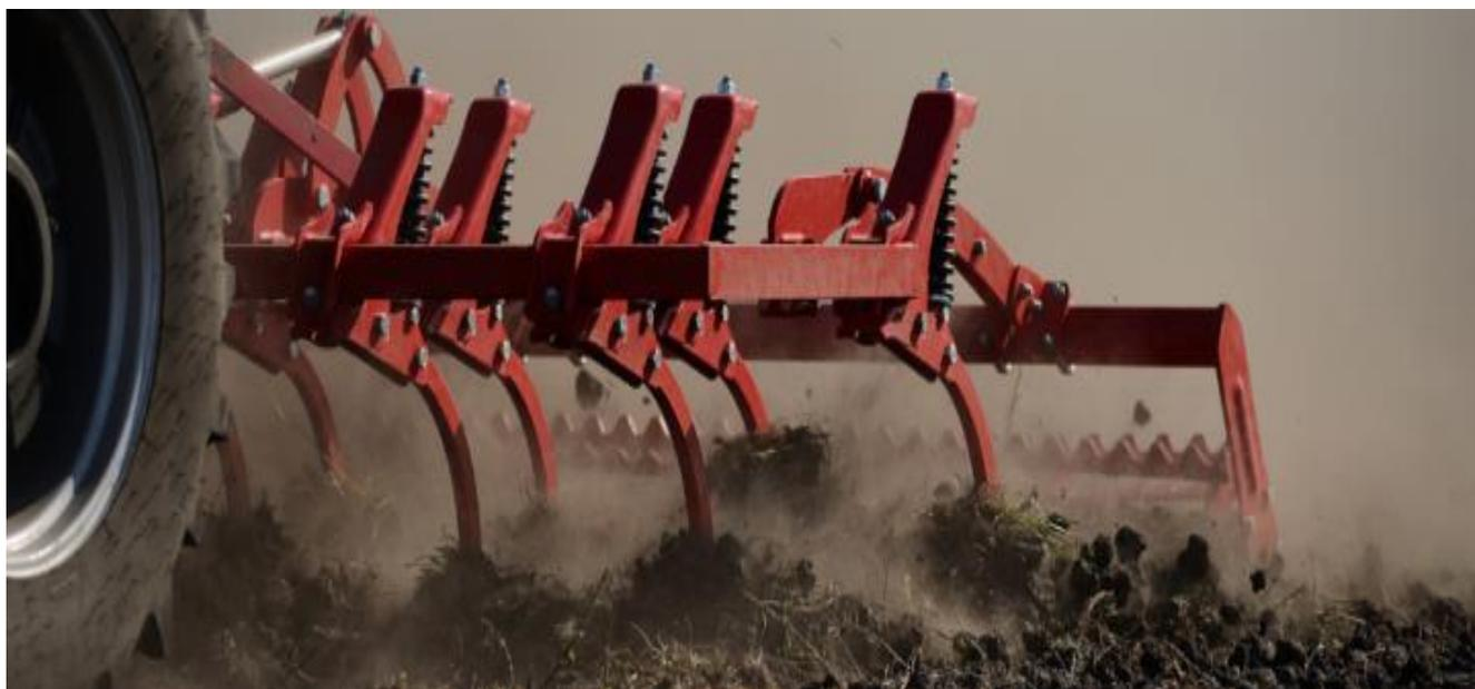
Figura 79– Estirpatore a molle con freccia (Triller a molle)
