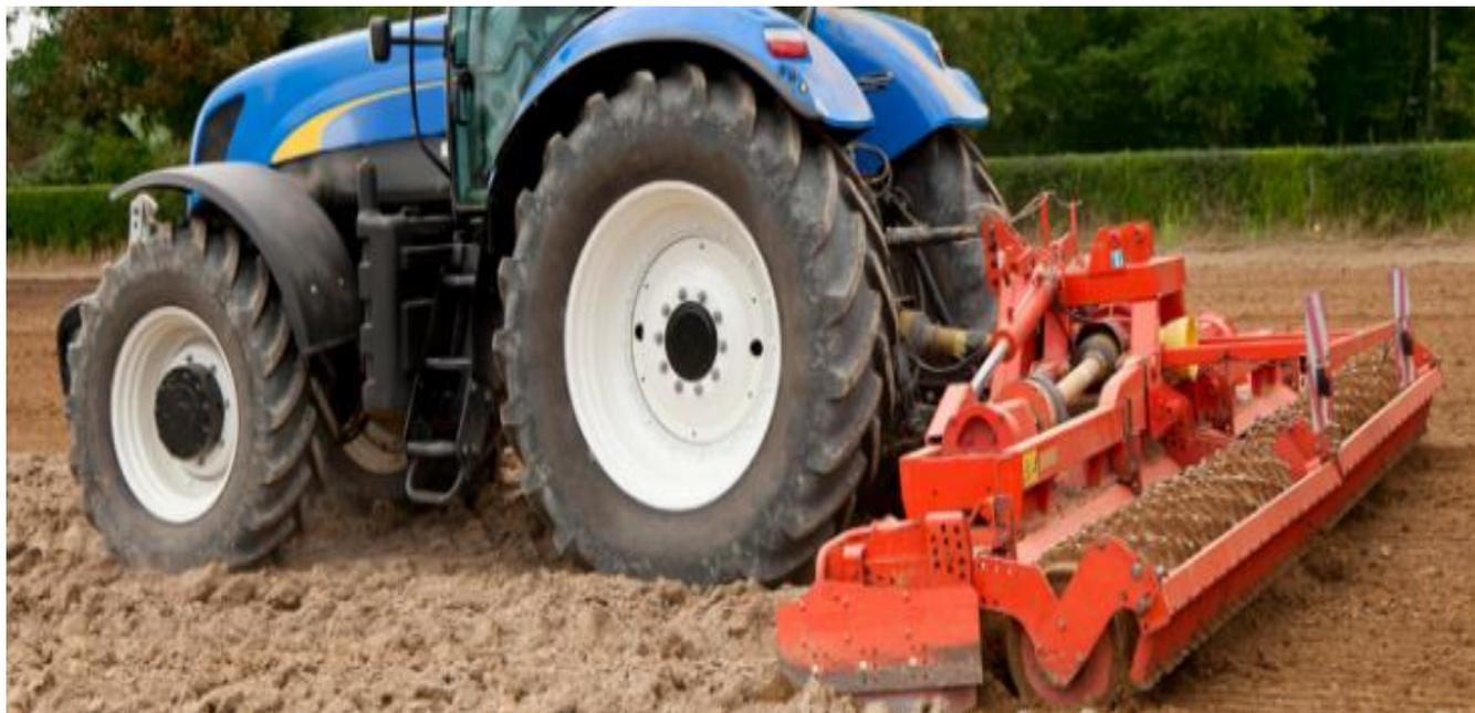
**Figura 78– Erpice rotante con rullo a prismi**
