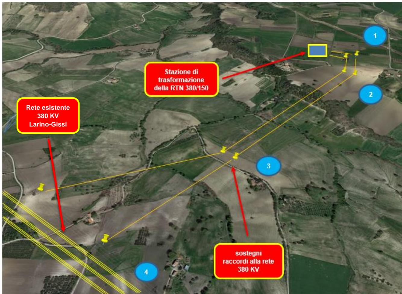
Figura 18– Raccordi di linea AT alla rete 380 KV – due linee con 8 sostegni – su foto satellitare
