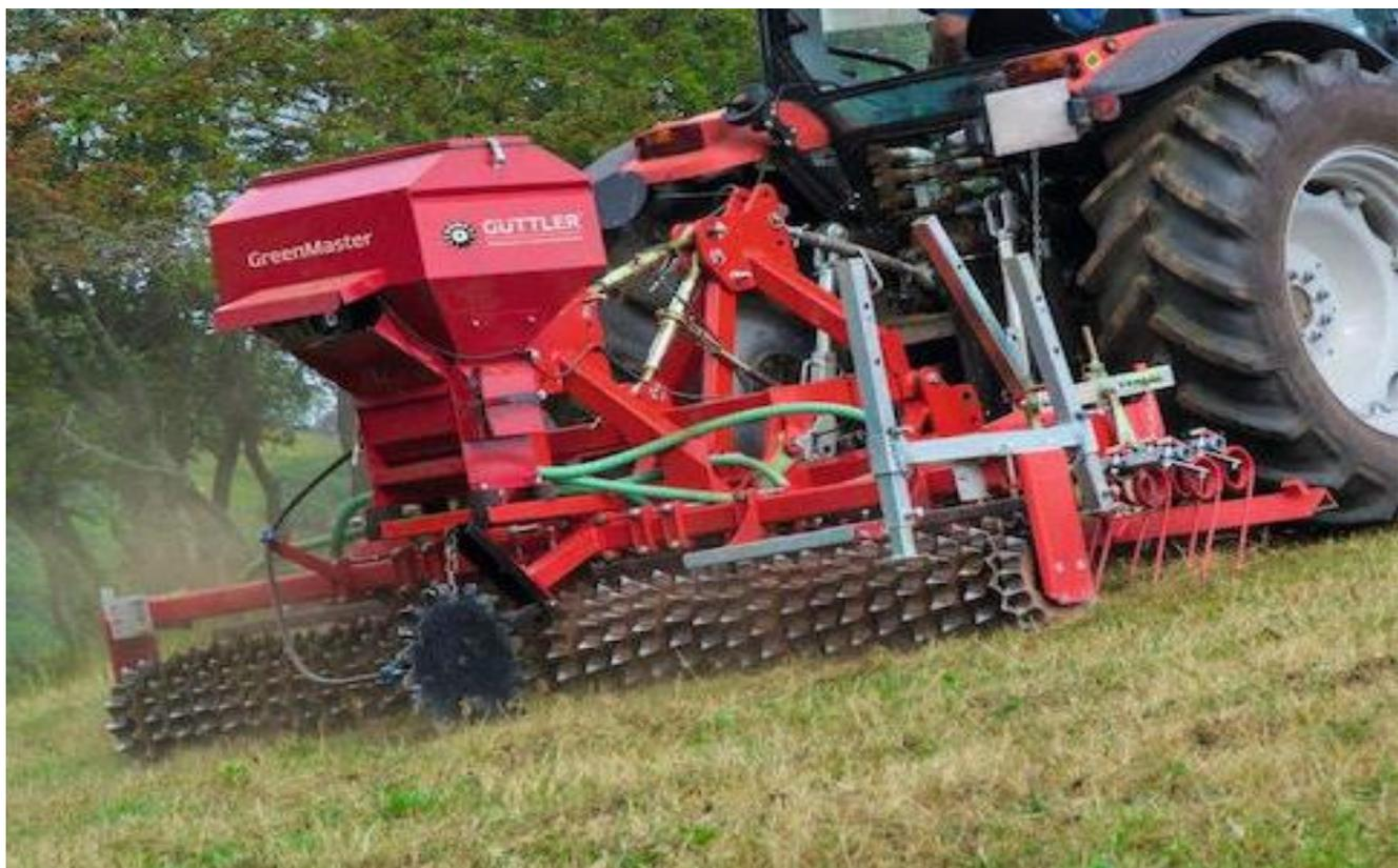
Figura 88– Traseminatrice con denti strigliatori e rullo a prismi
