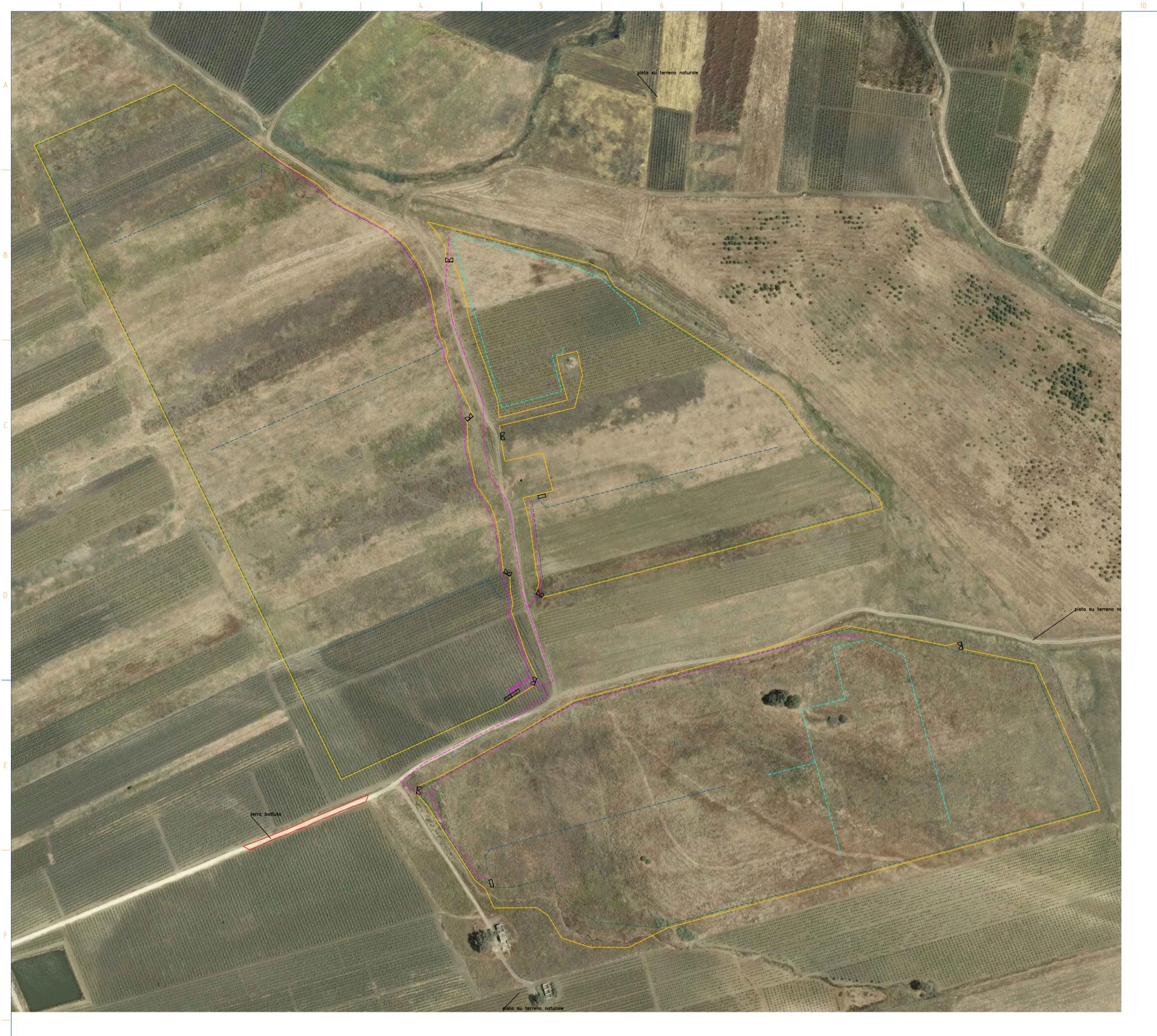
In linea tratteggiata sono rappresentati gli assi delle trincee per il posizionamento dei cavi interni al campo. I vari colori distinguono la sezione di scavo.
