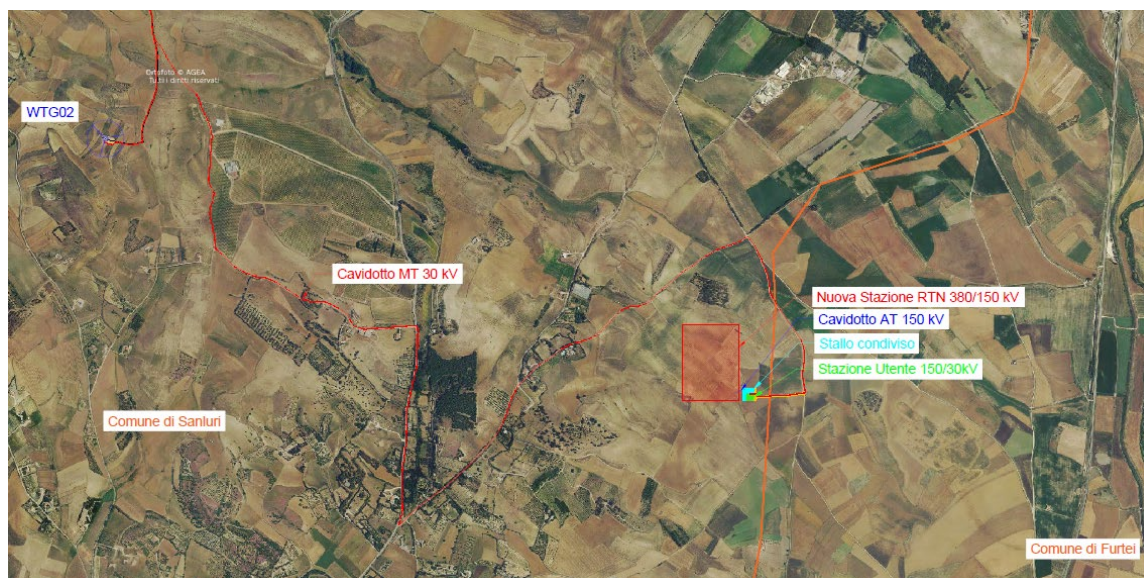
Figura 3-2 – Inquadramento generale da ortofoto – opere di connessione
