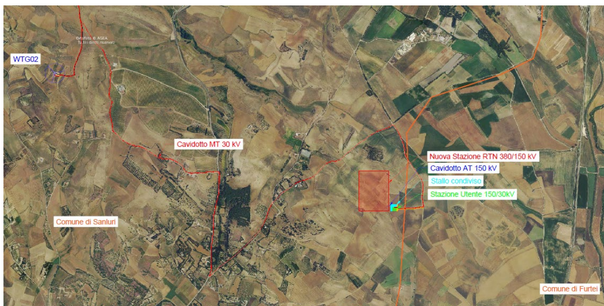
Figura 3-2 – Inquadramento generale da ortofoto – opere di connessione
