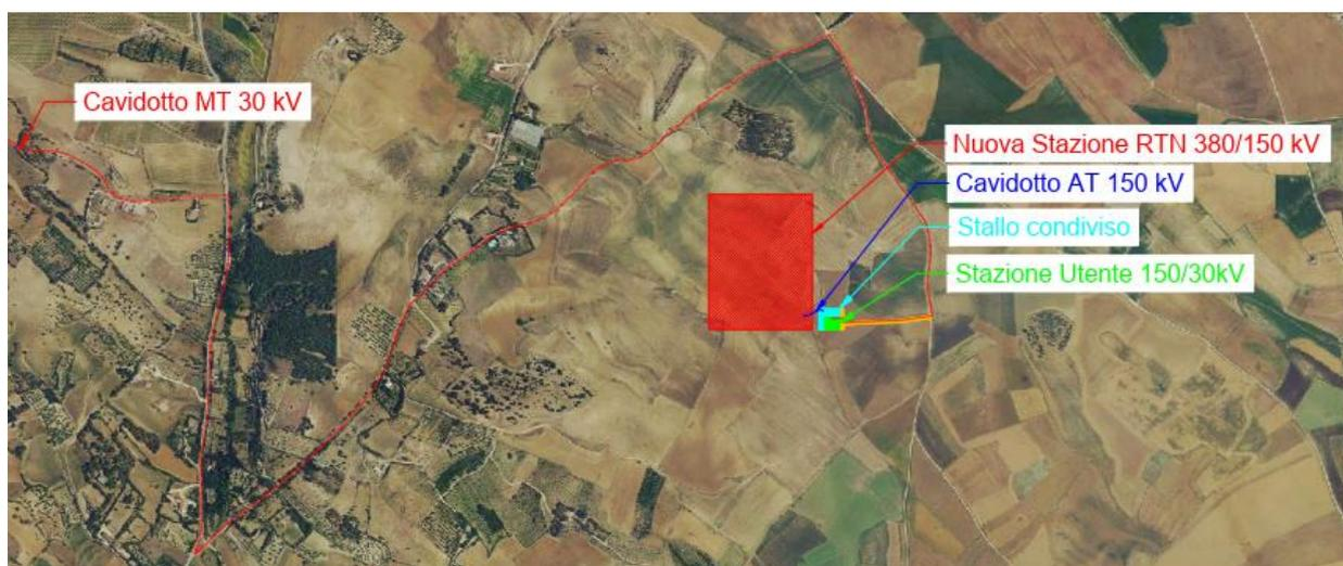
Figura 3-3 – Ubicazione opere di connessione su ortofoto
