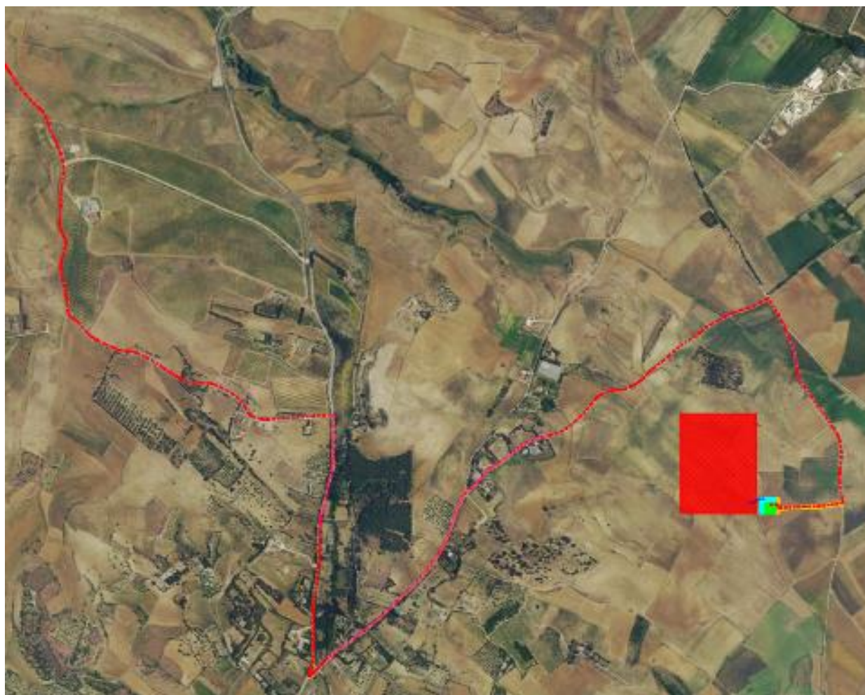
Figura 4-2 – Layout della rete MT su ortofoto – connessione alla SSE
