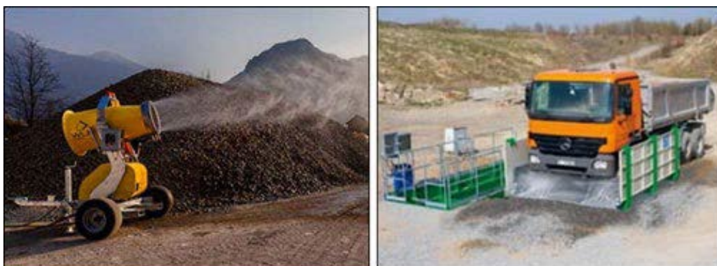
Fig. 7 - Esempio di Impianto di nebulizzazione mobile (immagine a sx) e di lavaggio ruote (immagine a dx) - (Fonte: web)
