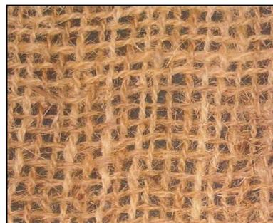
Figura 27 – Particolare geostuoia in fibra di cocco per il rivestimento dei fossi di guardia
