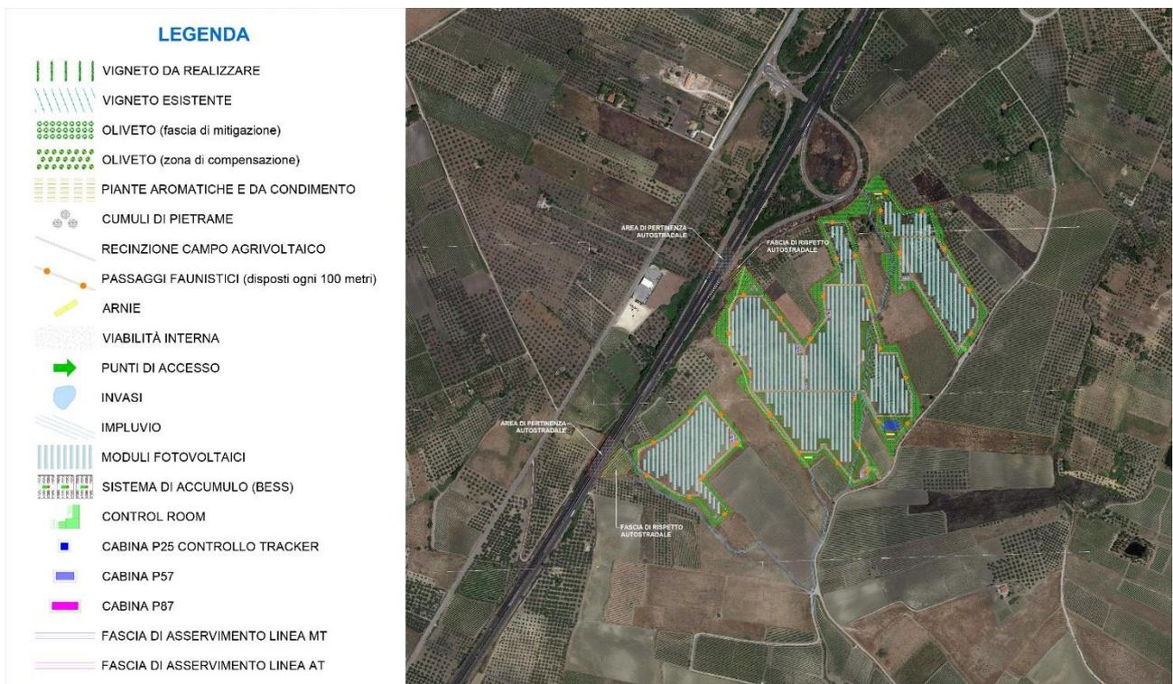
Figura 8 – Layout impianto agrivoltaico. Blocco A.
