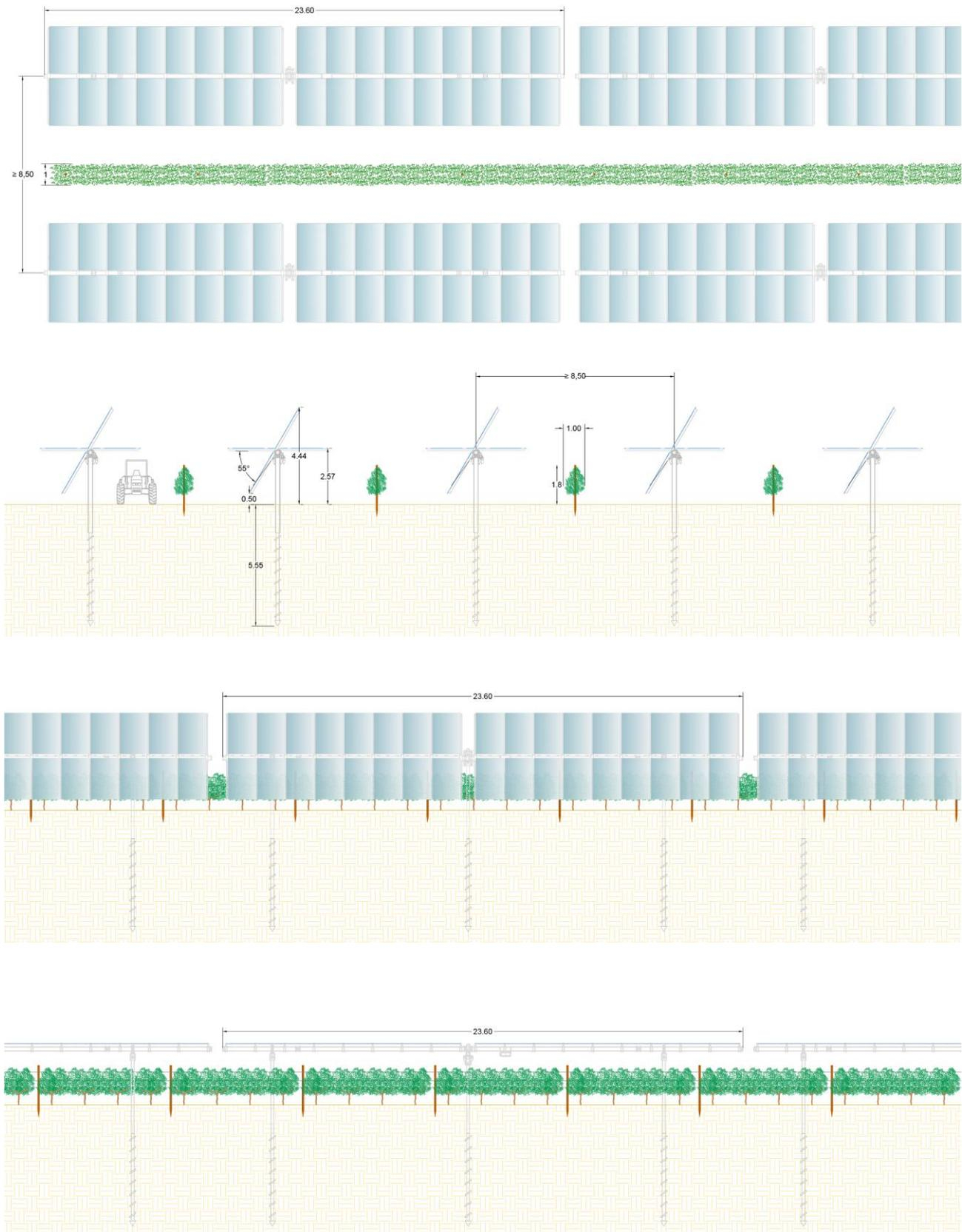
Figura 5 – Altezza e quota dei moduli fotovoltaici
