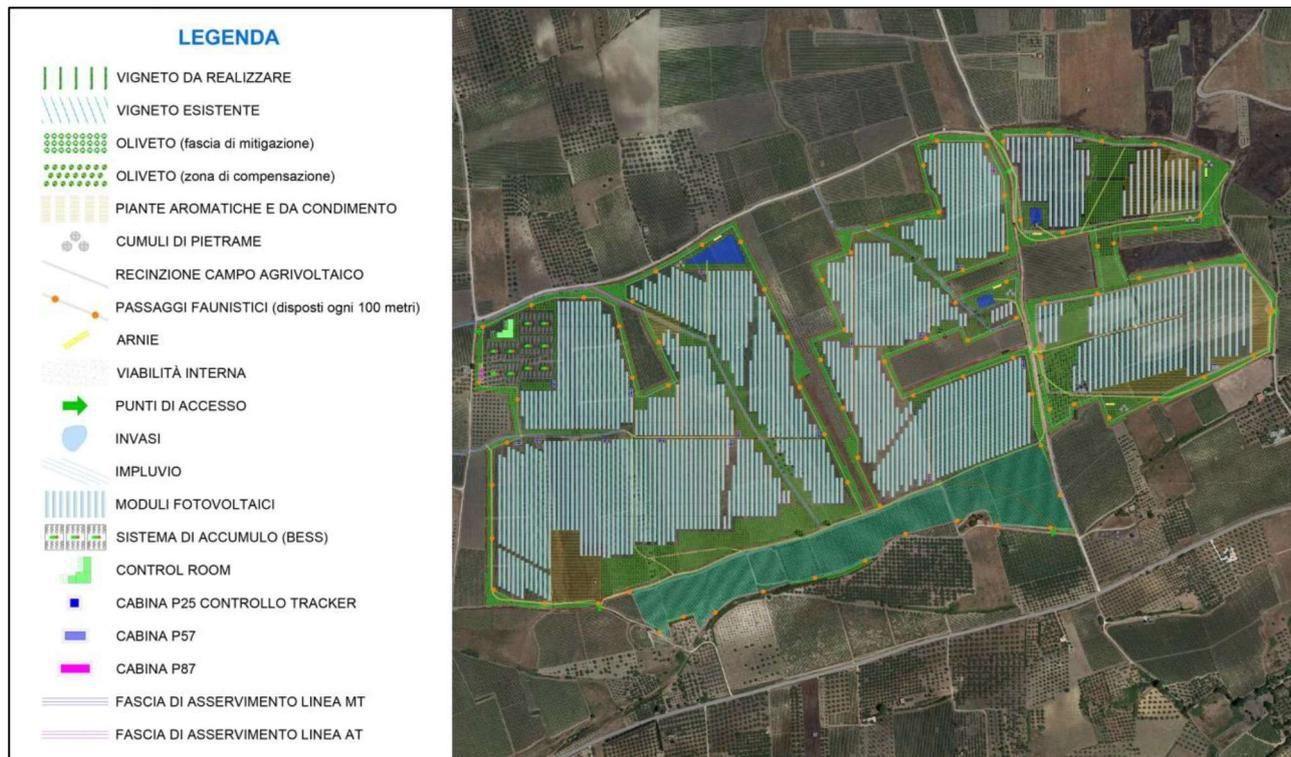
Fig. 9: layout di progetto (Blocchi A e B)
