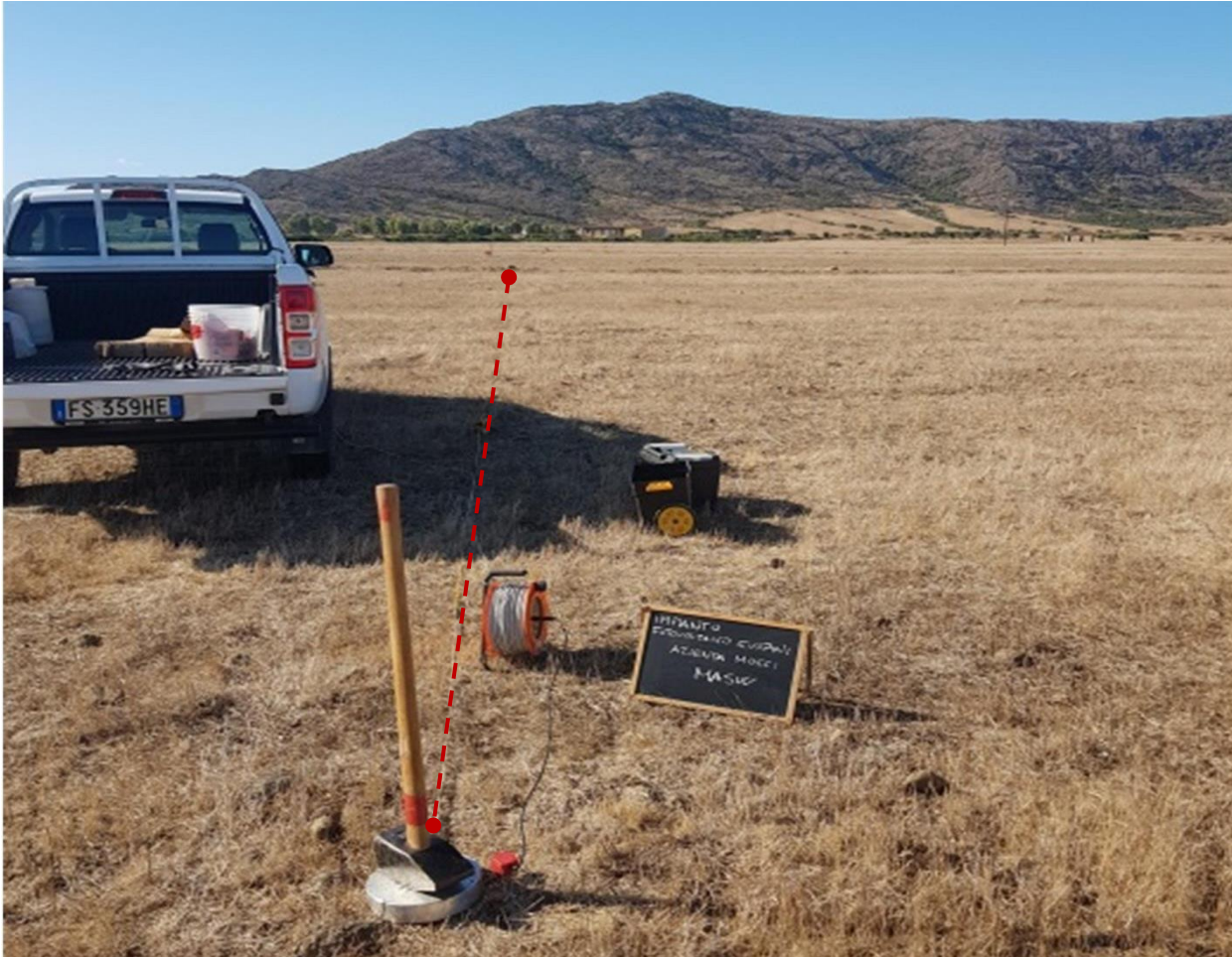
Figura 17 – Allineamento geofoni presso l'azienda Mocci
