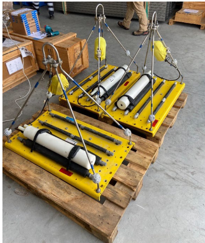
Figura 2.5: Foto degli strumenti proposti del relativo ancoraggio (© JASCO Applied Sciences)
