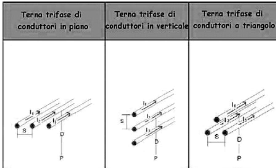
Figura 3 – Schemi dei sistemi trifase di conduttori rettilinei.
