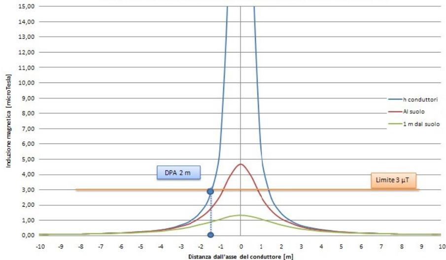
**Figura 6 : Andamento del campo magnetico in funzione della distanza dall'asse dei conduttori relativa alla simulazione S2**
