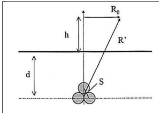
Figura 4 – Cavi unipolari interrati posati a trifoglio
