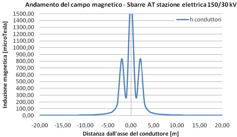
Figura 11: Andamento del campo magnetico in funzione della distanza dall'asse dei conduttori\_Sbarra AT stazione elettrica 150/30 kV – Valutazione della Distanza di Prima Approssimazione
