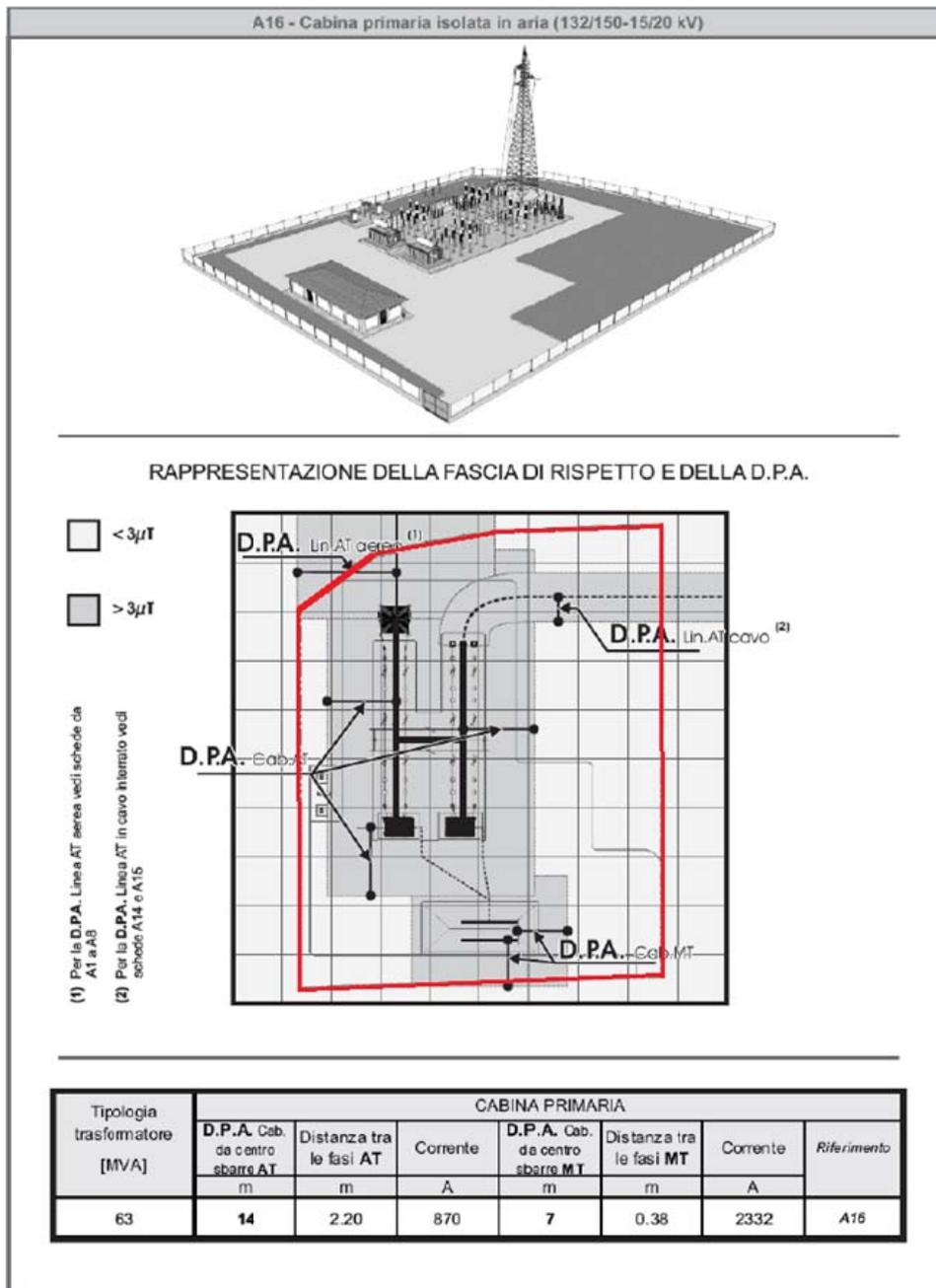
Figura 15 – D.P.A. per una Cabina di trasformazione AT/MT.
