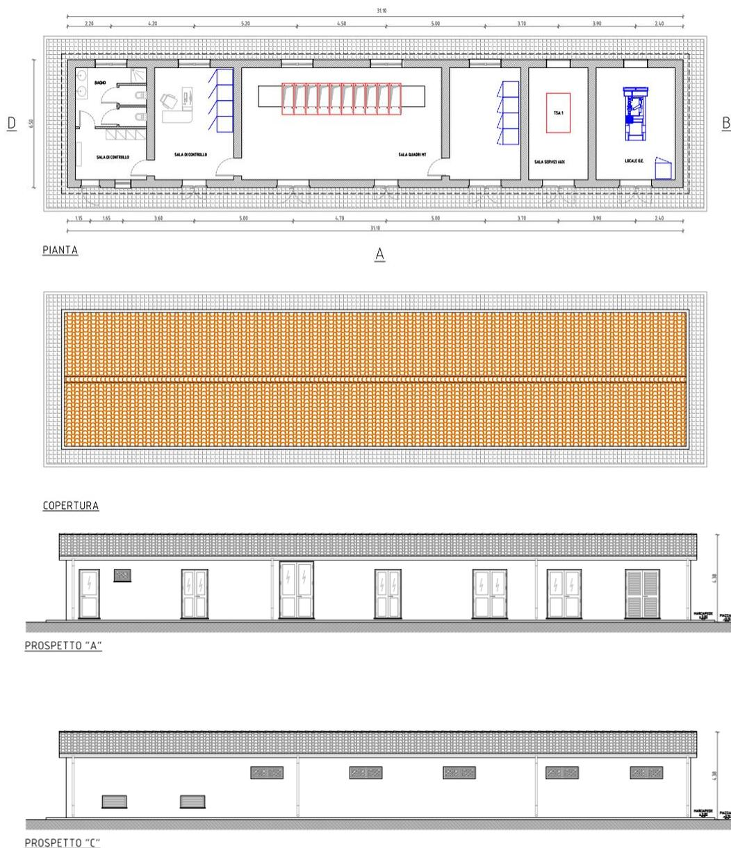
**Figura 40** – Cabina di Raccolta e Trasmissione
