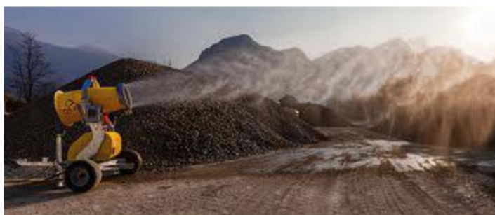
Impianto di nebulizzazione
