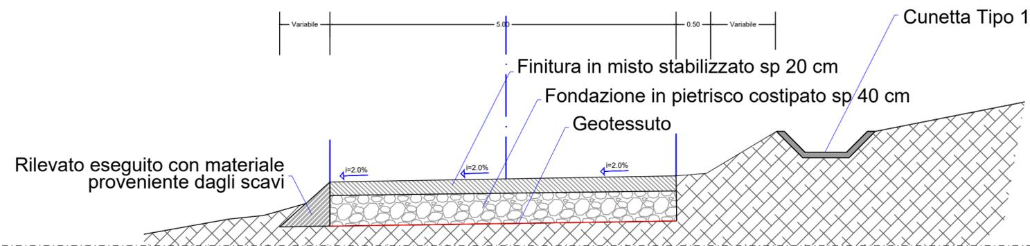
SEZIONE TIPO CON DRENAGGIO A MONTE E A VALLE\_SCALA 1:50
