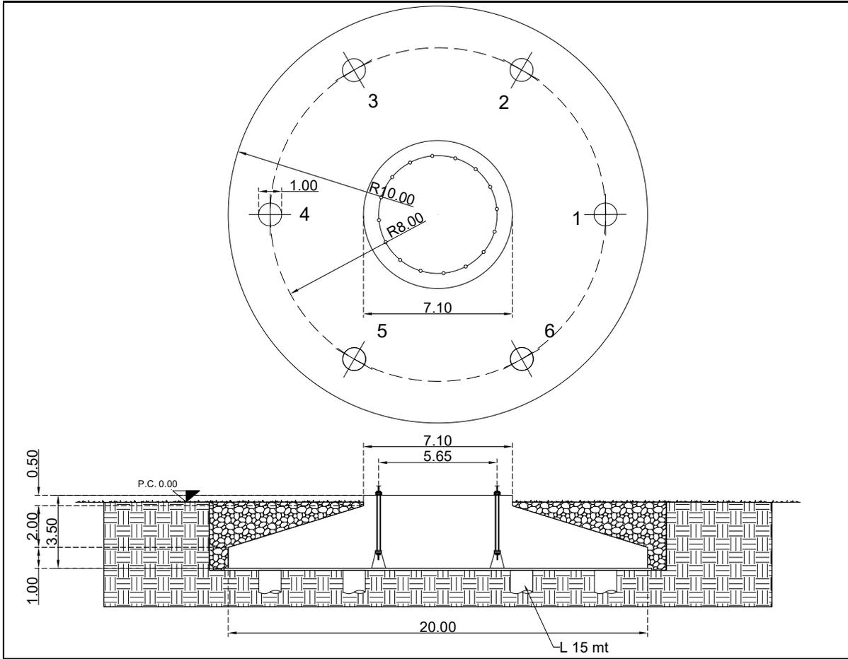
Figura 5.1.1: Dettaglio pianta e sezione fondazione
