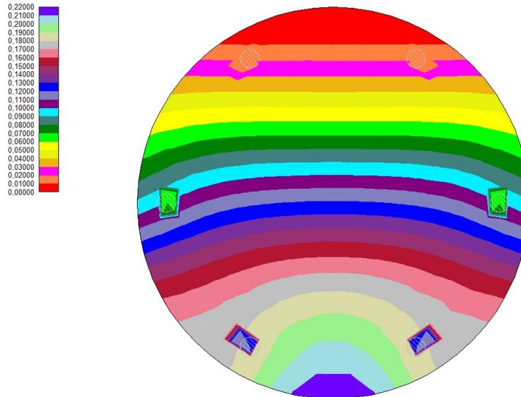
Figura 10.1.2 – Diagramma delle pressioni (unità di misura kg/cmq)
