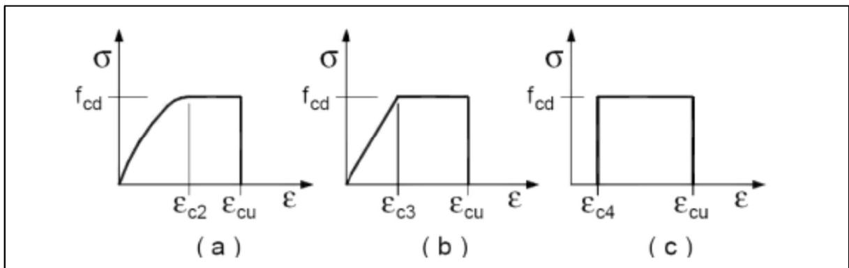
**Figura 4.1.1.1:** Diagrammi di progetto tensione-deformazione del calcestruzzo
