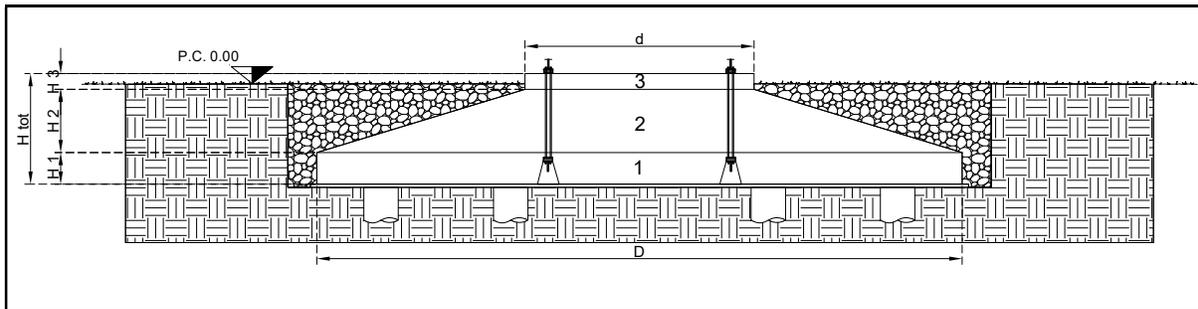
Figura 5.1.2: Dettaglio modello per calcolo volumi
