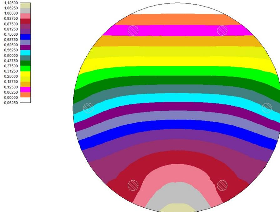
Figura 10.1.1 – Diagramma dei cedimenti (unità di misura cm)
