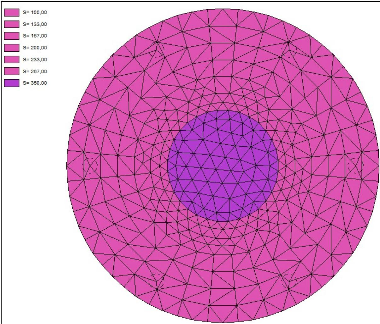
Figura 9.1.1: Spessori modellazione strutturale (unità di misura cm)
