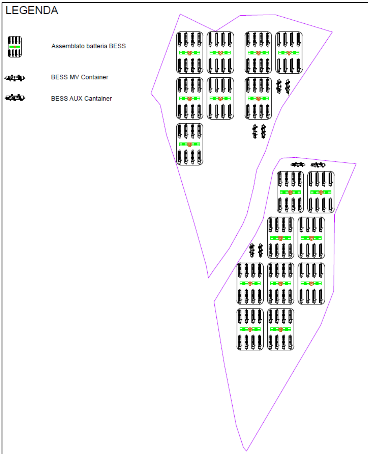
Figura 10.3: Configurazione BESS di potenza 64,8 MWp
