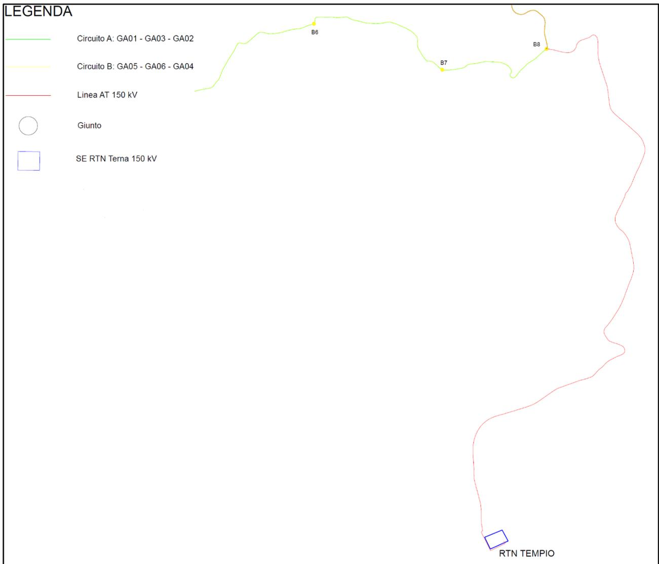
**Figura 4.5:** Dettaglio 3 - planimetria di distribuzione linee a 33 kV di collegamento tra gli aerogeneratori e arrivo linea a 150 kV alla SE RTN 150 kV
