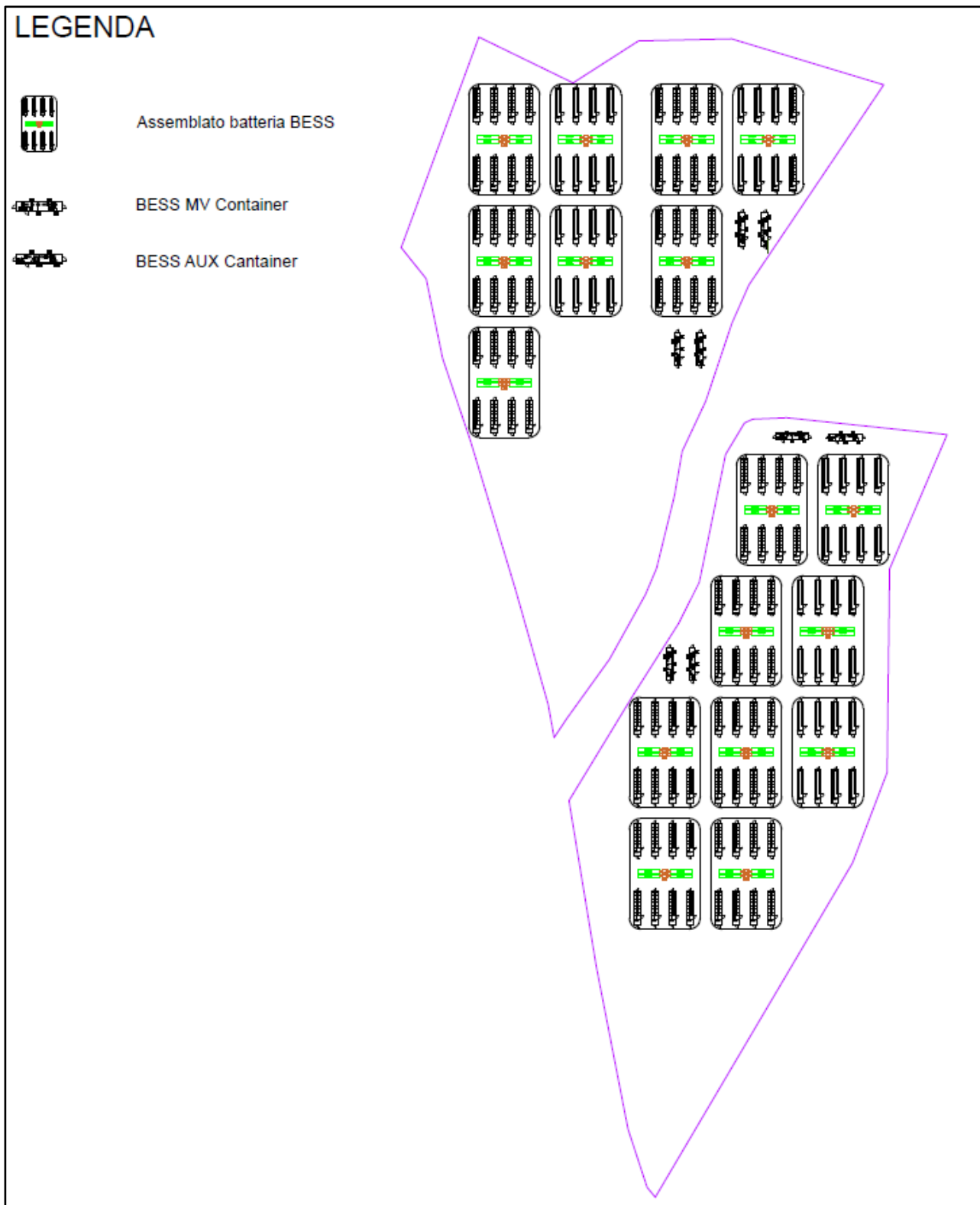
Figura 10.3: Configurazione BESS di potenza 64,8 MWp
