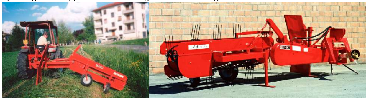
Figura 6.10: ranghinatore per argini e fossati risolve l'annosa e faticosa rastrellatura manuale dell'erba nei fossi, nei canali e sugli argini, ma è adatto anche alle normali operazioni in piano (Foto: Cucchi)
