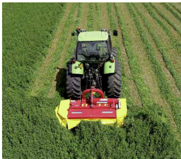
Figura 6.9: Esempio di falciacondizionatrice interceppo posteriore (Foto: Bellon)
