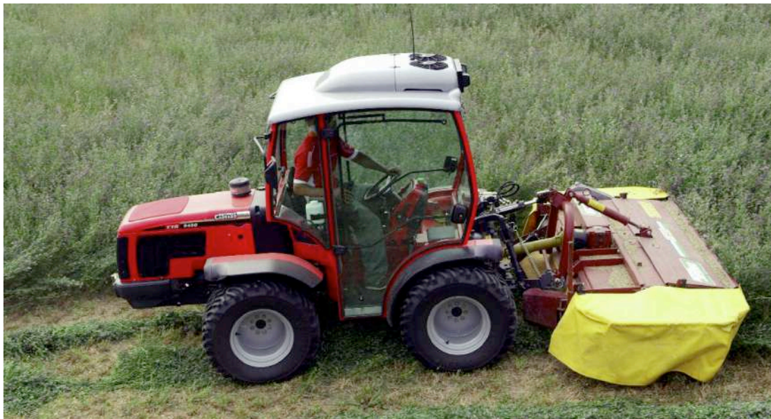
Figura 6.8: Esempio di falciacondizionatrice frontale adatta a piccoli spazi (Foto: Bellon)
