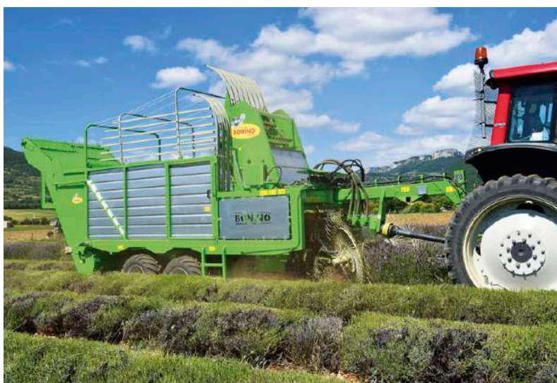
Figura 6.5: Raccogliitrice meccanica di lavanda trainata e relative specifiche tecniche (Foto: Bonino S.a.s.)
