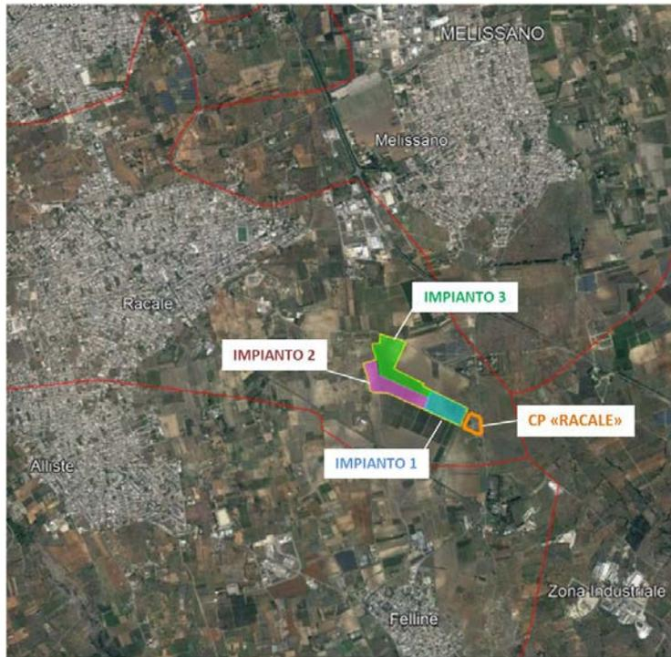
Figura 1 - Stralcio su ortofoto dell'impianto FV con indicazione della connessione alla CP Racale in MT-20 kV
