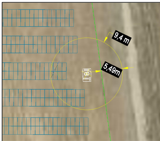
Figura 2 – DPA della cabina di trasformazione n.12 con trafo da 1800 kVA
