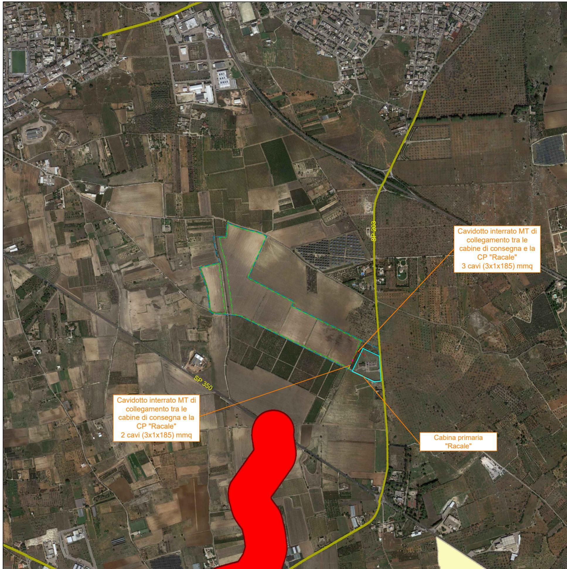
Cavidotto interrato MT di collegamento tra le cabine di consegna e la CP "Racale" 2 cavi (3x1x185) mmq
