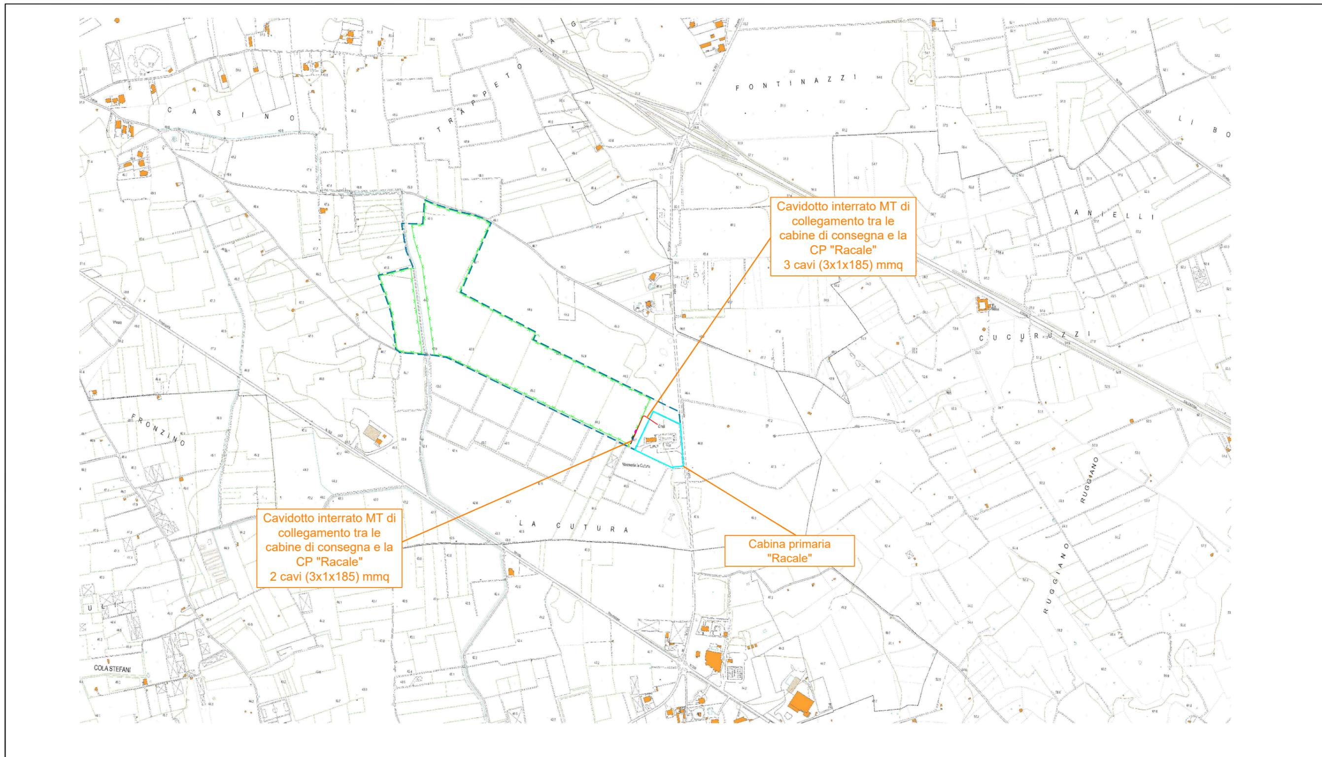
Cavidotto interrato MT di collegamento tra le cabine di consegna e la CP "Racale" 3 cavi (3x1x185) mmq
