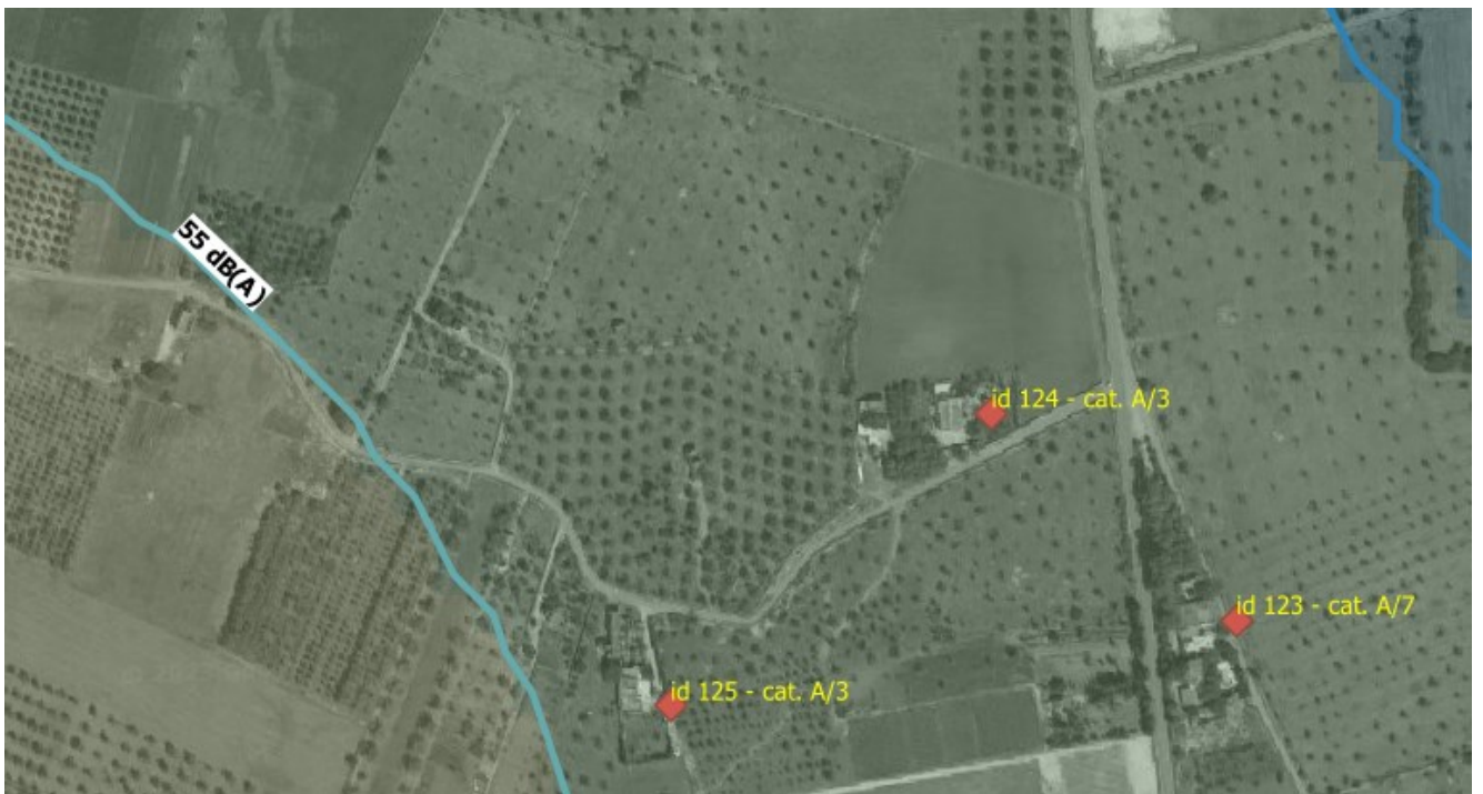
Isofone in corrispondenza dei ricettori a nord-est della SSE
