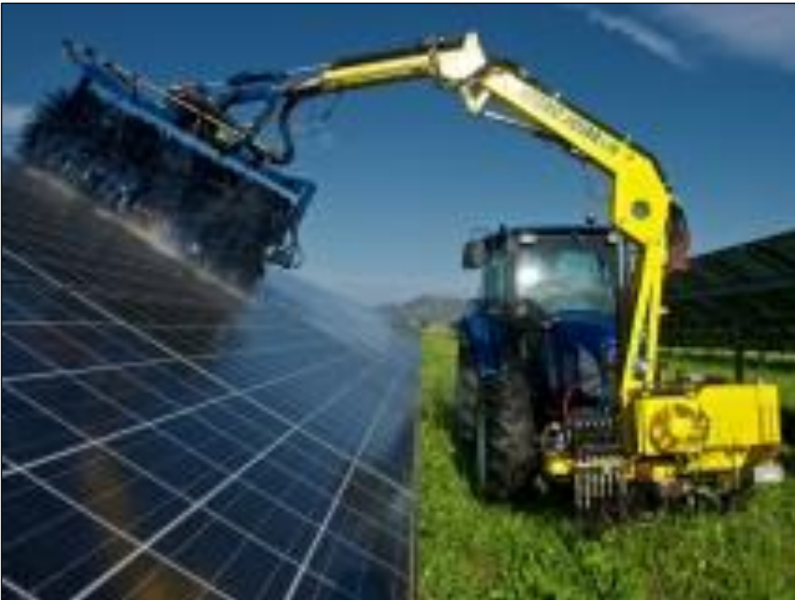
Fig.: Tipico macchina per pulizia moduli FV
