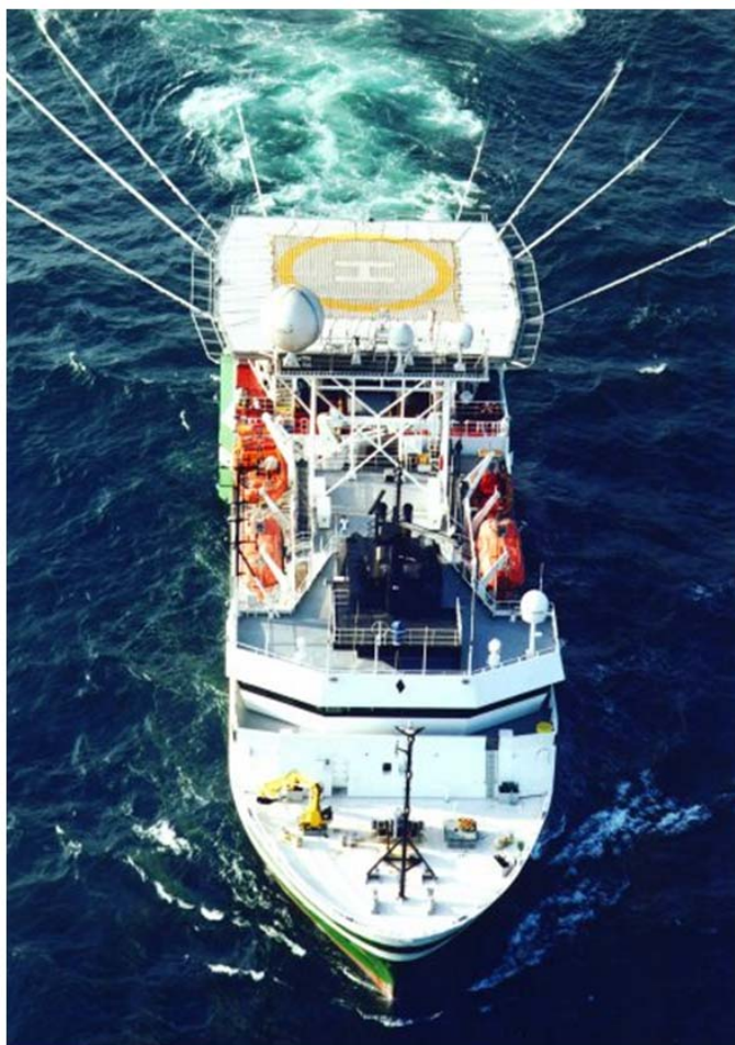
Figura 1-9: esempio di nave per ricerca geofisica impegnata in un rilievo sismico 3D con una configurazione a otto cavi (Fonte: eni s.p.a. divisione e&p)
